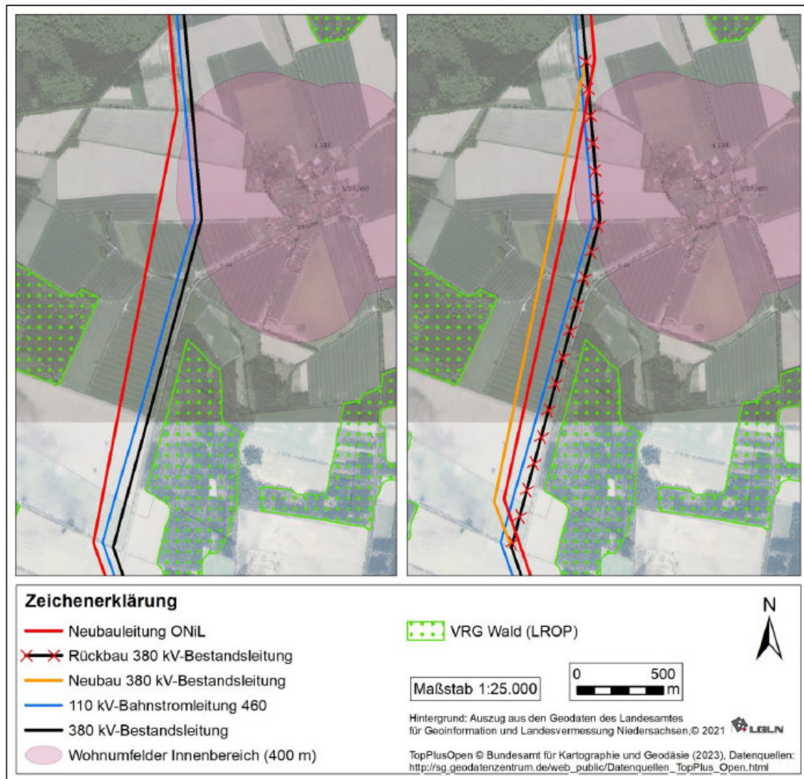
Abbildung 8: Vergleich Bündelung östlich/westlich der Bestandsleitungen - westl. Velgen
