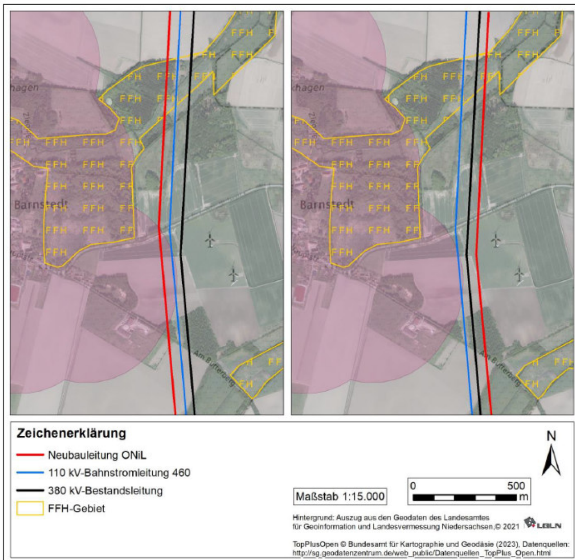
Abbildung 7: Vergleich Bündelung östlich/westlich der Bestandsleitungen - östl. Barnstedt
